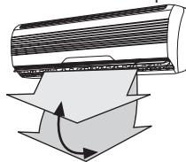
Обогрев: Когда температура выпускаемого воздуха низкая, жалюзи направления вертикального потока займут горизонтальное положение, а при повышении температуры они опустятся вниз.
