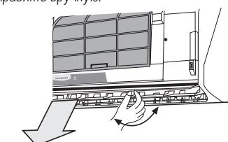
Чтобы отрегулировать горизонтальное направление воздушного потока, двигайте вручную Жалюзи Горизонтального Направления Воздушного Потока.
