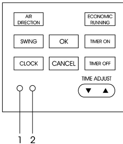
1. При нажатии кнопки “LOCK” (БЛОКИРОВКА) все кнопки пульта ДУ блокируются. Пользуйтесь кнопкой LOCK для предотвращения случайного изменения настроек кондиционера.
