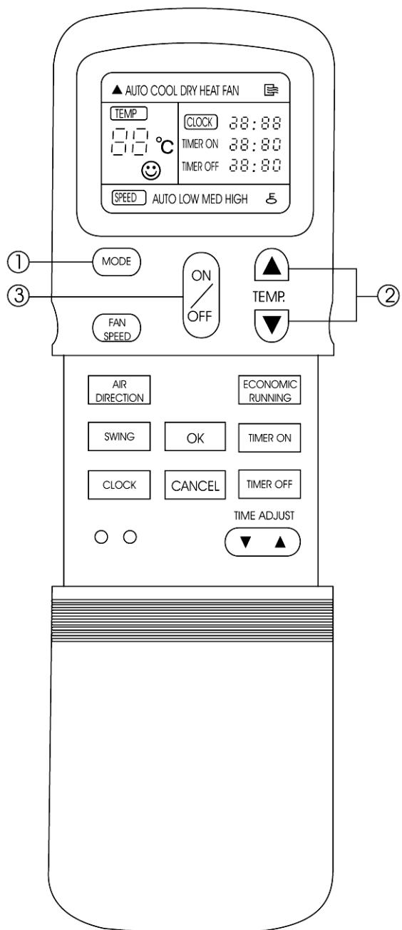
В автоматическом режиме работы микропроцессор кондиционера автоматически выбирает режим ОХЛАЖДЕНИЯ, ОБОГРЕВА (для моделей с режимом обогрева) или ВЕНТИЛЯЦИИ по разности между заданной и фактической температурой воздуха в помещении. При отключении кондиционера текущие настройки сохраняются в памяти микропроцессора. При последующем включении нажатием кнопки пульта ДУ "ON/OFF" (ВКЛ/ОТКЛ) кондиционер начнет работать с ранее заданными настройками.
